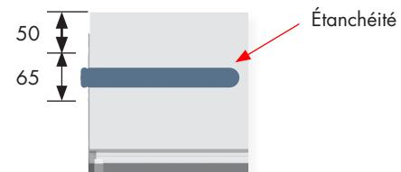
**Remarque :** pour la cote AT comprise entre 85 et 156 ou égale à 0, la trappe de visite est plus courte pour s'ouvrir de face sans détériorer l'environnement du volet notamment dans le cas d'un retour de peinture sur l'embout.
